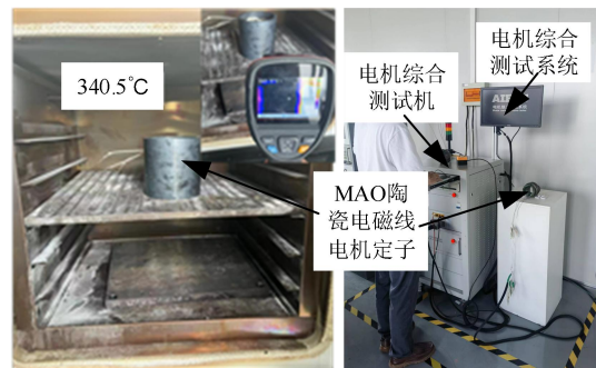
图 7 样机定子绕组测试实验
